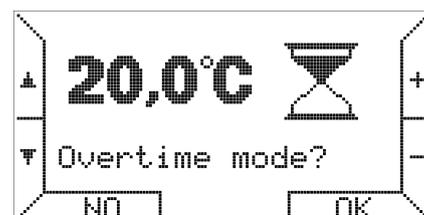
une température pour une durée définie par l'utilisateur. La durée d'une seule étape est à 15 minutes, la durée maximale est de 240 minutes.
