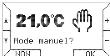
Il suffit d'appuyer sur les boutons + et - pour faire varier la température. Activez le mode manuel en appuyant sur le bouton OK.
